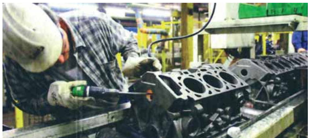
Abb. 3 Frisch gegossene Motorblöcke werden am Band von Sand gesäubert und per Hand nachbearbeitet Foto: Beißel, we/ Eisenwerk
